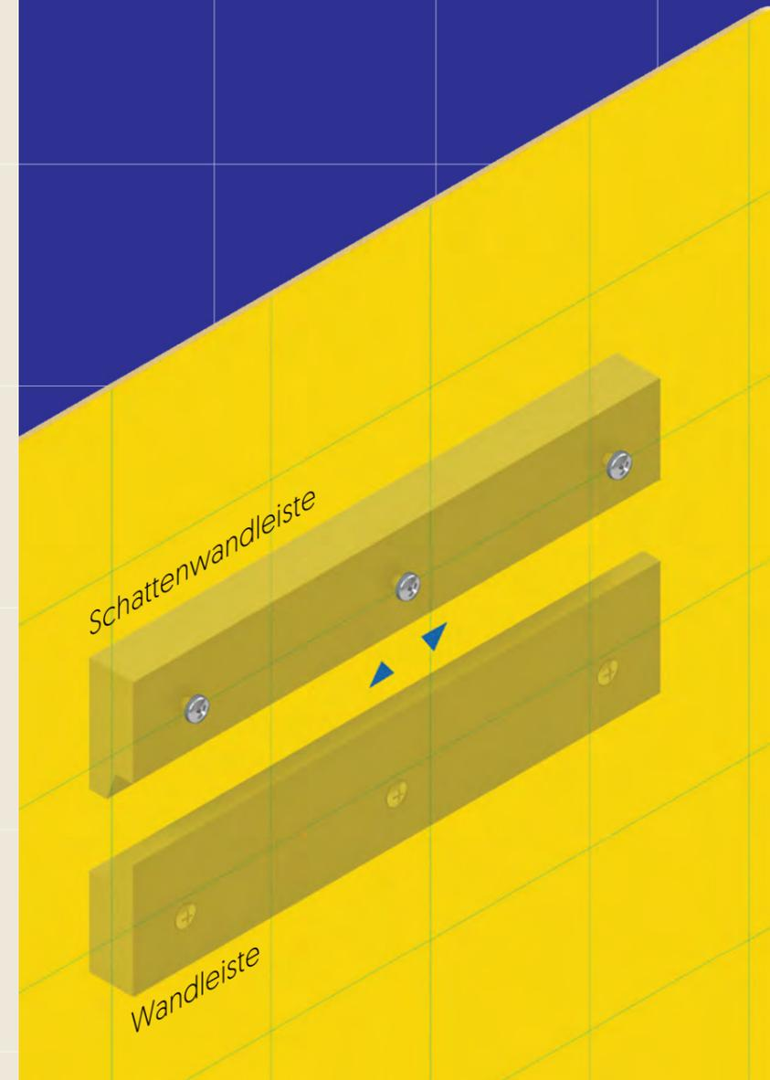
KOBRA Schattenwände werden mit **HACCP-konformen Montageleisten** an der Wand montiert und können **ganz ohne Werkzeug** aufgehängt und wieder abgenommen werden.
