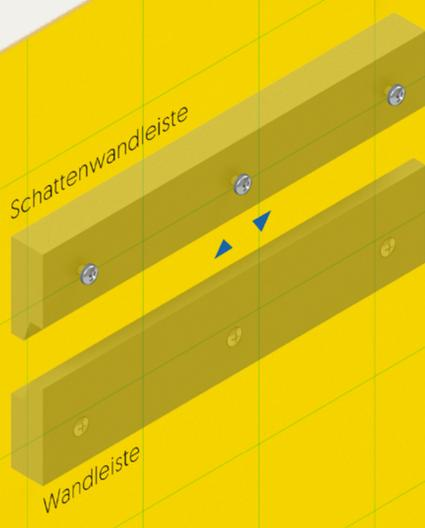
KOBRA Schattenwände werden mit HACCP-konformen Montageleisten an der Wand montiert und können ganz ohne Werkzeug aufgehängt und wieder abgenommen werden.
